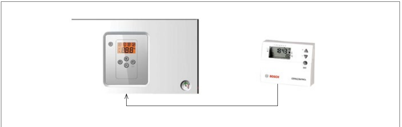
5/2 Комбинация регулятора комнатной температуры TRZ 12-2 (вкл./выкл) с панелью управления газового конвекционного котла Gaz 6000 W.
