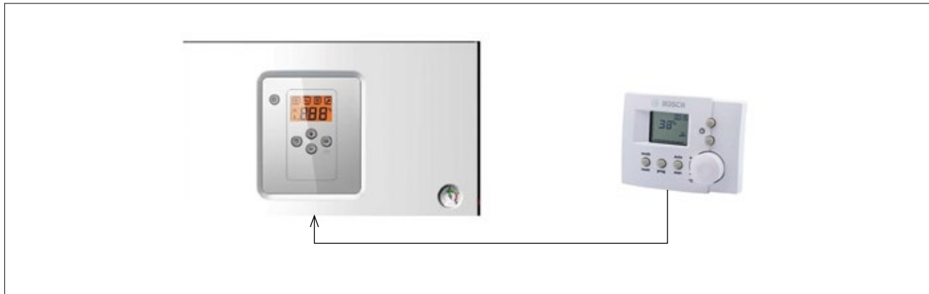
5/1 Комбинация программируемого регулятора комнатной температуры OpenTherm™ CR12005 с панелью управления газового конвекционного котла Gaz 6000 W.
